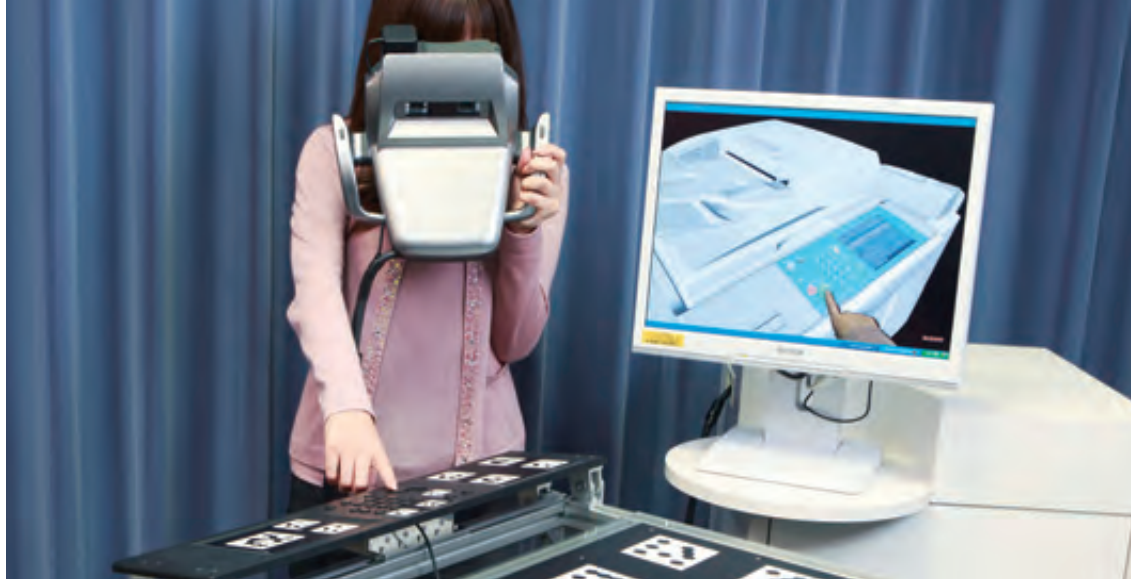
MRIによるオフィスネットワーク複合機の操作シミュレーション(ディスプレイ画面内の映像が、HMDに映し出されています)
