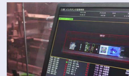
インクカートリッジの自動リサイクルシステム (CARS-I) カメラによる使用済みインクカートリッジの識別技術
