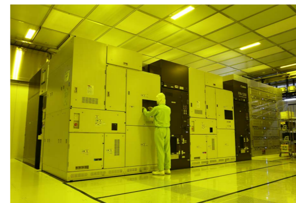
東芝メモリに導入されたナノインプリントリソグラフィ技術を用いた半導体露光装置
