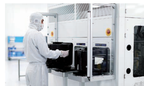
Les équipements de pulvérisation de Canon ANELVA déposent un film uniforme de taille nanométrique sous vide
