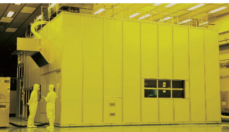
Les équipements lithographiques FPD de Canon exposent les tracés de circuits sur des substrats en verre
