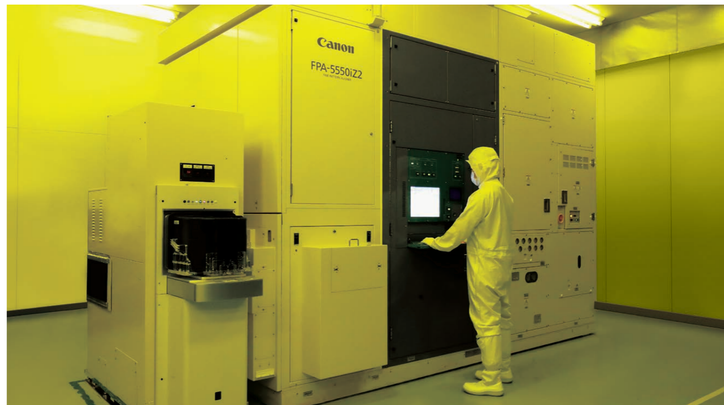
Stepper « i-line » utilisé dans la fabrication de dispositifs de mémoire, de capteurs d'image, etc.
