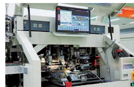
Les microsoudes de puces de Canon Machinery assurent rapidité et haute précision
